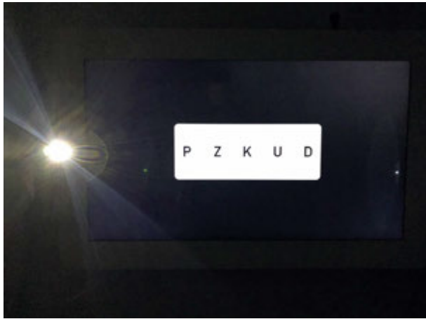
Abb. 4: Der Vissard 3D (Oculus Optikgeräte GmbH) während der Dunkelrefraktion und zuschaltbarem LED-Blendeffekt links ■ Fig. 4: The Vissard 3D (Oculus Optikgeräte GmbH) during dark refraction and switchable LED glare effect on the left
