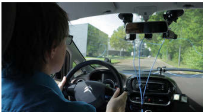
„DriveSafe“ von Zeiss: Während einer Autofahrt wird der Blickverlauf des Testträgers gemessen. (Foto: Zeiss)
