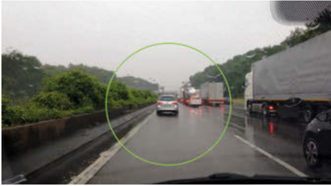
Abb. 9: Zentrales und peripheres Sehen bei Annäherung an ein Stauende. Der eingezeichnete Kreis entspricht dem Gesichtsfeld bis zu einer Exzentrizität von 20 Grad. Der am rechten Bildrand zu erkennende schwarze Pkw stellt ein potenzielles Unfallrisiko dar. Wird er nicht erkannt und versucht der Fahrer auf die mittlere Spur auszuweichen, um „schneller“ voranzukommen, könnte es zu einer Kollision kommen.
